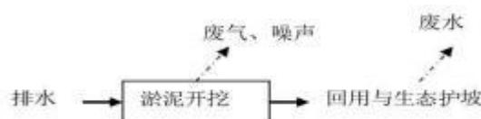
图 2-1 淤泥开挖施工工艺流程
